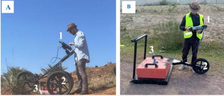
شكل 6: الهوائيات المستخدمة في جمع البيانات: A بتردد 400 MHz ، B بتردد 200MHz ، (1) وحدة التحكم، (2) عجلة المسح المزودة بمشفر حركة، (3) الهوائي (Mojahid et al, 2025)
