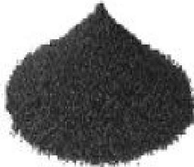
شكل (3-3) ألياف الكربون المطحونة
