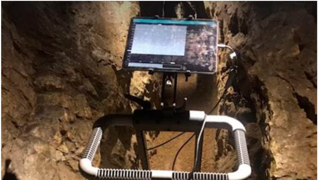
شكل 1: صورة للاستكشاف في منجم باستخدام رادار اختراق الأرض (المصدر: screeningeagle.com)
